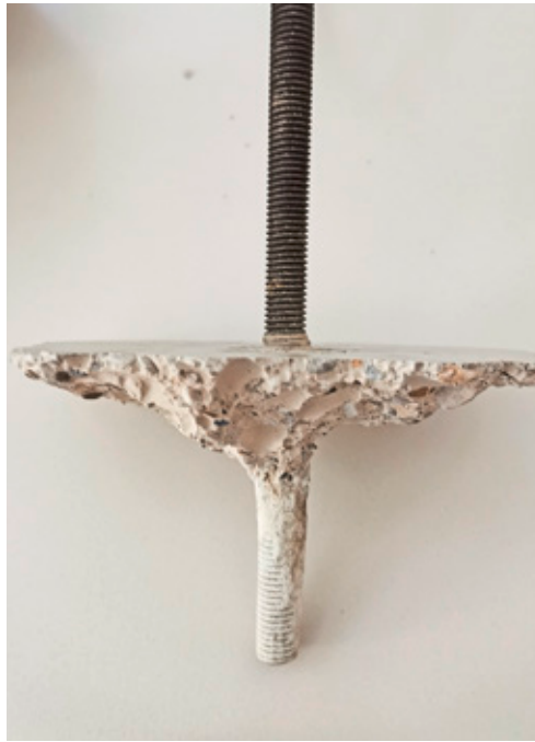
Kombiniertes Versagen eines Verbunddübels
